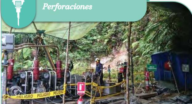
En Fruta de Norte se han realizado perforaciones de hasta 1.200 metros de profundidad para definir la forma y dimensiones del depósito mineral. Para descubrir FDN, se desarrollaron 553 pozos, que equivalen a 184.789 metros de perforación.
